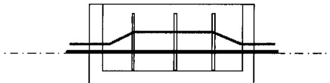
L'Opérateur utilise les supports de câbles existants. En aucun cas il ne doit déplacer, substituer ces supports par des supports qui lui sont propres.
